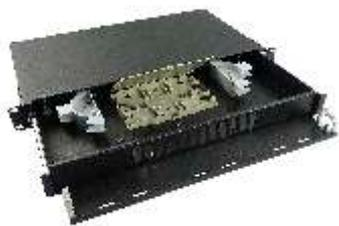
Cassetto Ottico (comprensivi di carpenteria, avvolgi cavo a ragno, vassoio porta giunti) utilizzato per la terminazione di cavi in fibra ottica all'interno di armadi rack con montanti regolabili.
