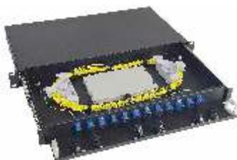
Cassetto ottico estraibile non assemblato (disponibile nella versione a 6, 12 e 24 posizioni vuote per bussole SC Simplex) idoneo per la terminazione dei cavi in fibra ottica all'interno di armadi 19" con montanti regolabili.
