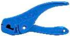
Lo strumento BTR-6 permette un rapido accesso alle fibre ottiche contenute all'interno dei tubetti (con spessori da 0,2 mm a 0,5 mm) dei cavi in fibra ottica "loose Type". Consente inoltre la rimozione del buffer (da 1.2 mm a 6 mm) dalle fibre ottiche. Leggero e resistente è dotato di una lama in acciaio temprato che conferisce un taglio preciso e una lunga durata.
