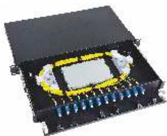
Cassetto ottico estraibile non assemblato (disponibile nella versione a 6, 12 e 24 posizioni vuote per bussole LC Duplex) idoneo per la terminazione dei cavi in fibra ottica all'interno di armadi 19" con montanti regolabili.
