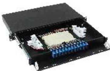
Cassetto ottico estraibile non assemblato (disponibile nella versione a 6, 12 e 24 posizioni vuote per bussole SC Duplex) idoneo per la terminazione dei cavi in fibra ottica all'interno di armadi 19" con montanti regolabili.
